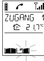
2. Der Türöffner des anrufenden Zugangs wird innerhalb von 5 Sekunden entsperrt.
