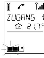
2. Die anrufende Zugangssperre wird innerhalb von 5 Sekunden entsperrt.
