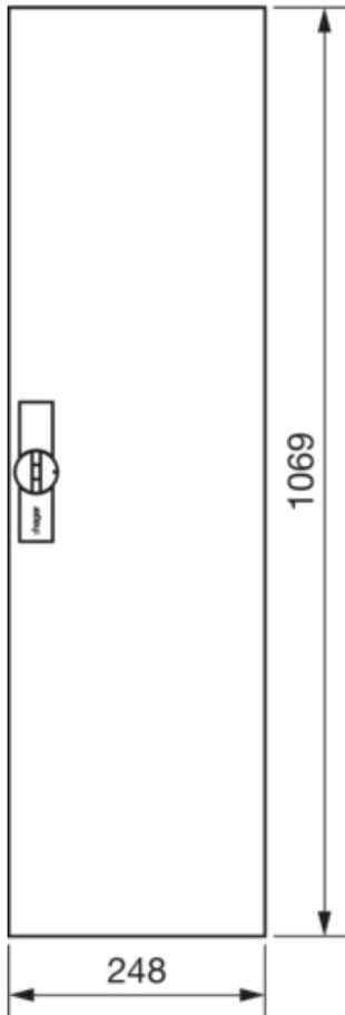
**Sondertür, univers, voll, rechts, RAL 9010, für Schrank IP44, 1100x300mm**
