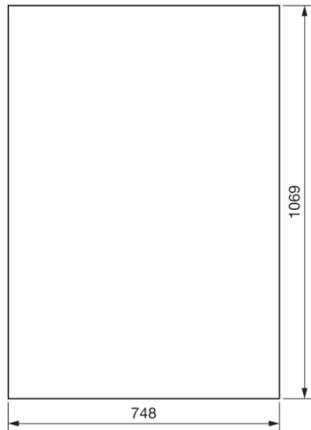
**Tür, univers, links, geschlossen, RAL 9010, für Schrank IP44/54 1100x1300mm**
