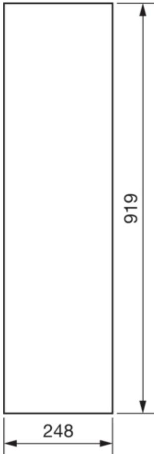
**Tür, univers, links, geschlossen, RAL 9010, für Schrank IP44/54 950x800mm**
