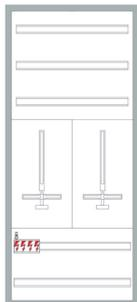
**Zählerverteiler, EVN Netz GmbH, 2 Zählerplätze, 78 Platzeinheiten**
