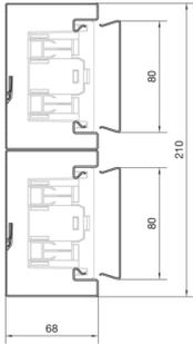
**Brüstungskanal-Unterteil aus Stahl zu BRS 70x210mm Oberteil 2x80mm verzinkt**
