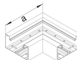
**Flachwinkel schnittkaschierend PC - ABS**
