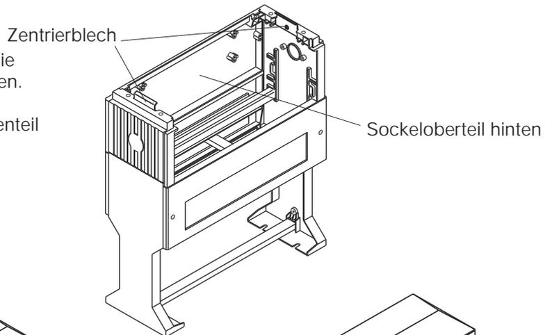
7. KVS auf Sockel setzen und mit beiliegendem Bausatz befestigen.
