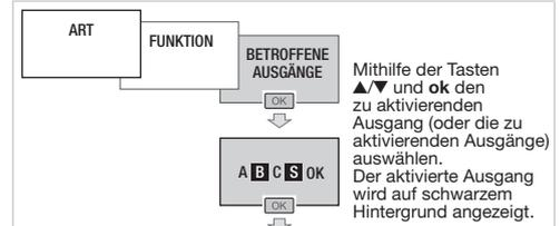
Mithilfe der Tasten **▲/▼** und **ok** den zu aktivierenden Ausgang (oder die zu aktivierenden Ausgänge) auswählen. Der aktivierte Ausgang wird auf schwarzem Hintergrund angezeigt.
