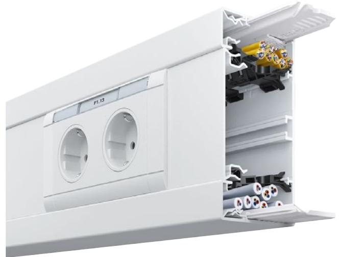
Mit seinem bewährten 3-Kammer-System zur Trennung von Energie- und Datenleitungen erfüllt der neu gedachte tehalit.BRN65 alle relevanten Normen für strukturierte Datenverkabelung. Bei IT-Anwendungen ist er daher die erste Wahl. Denn hier bietet der tehalit.BRN65 von Hager einzigartige Vorteile.
